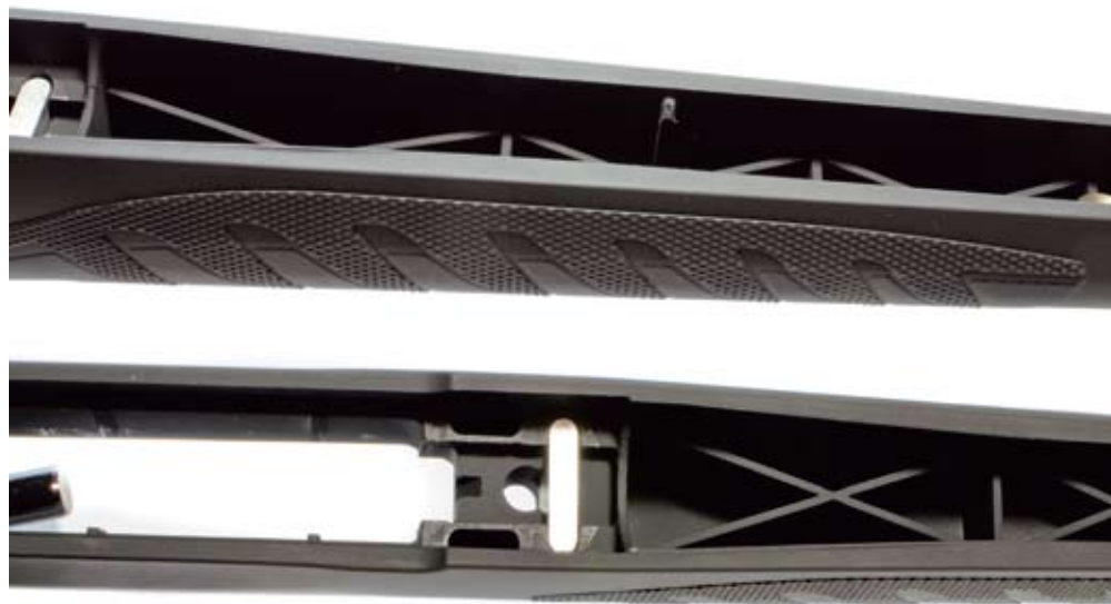
Tukki on rakenteeltaan ontto ja siinä on jäykisteet. Rekyylivaste on kohta, joka saattaa vaatia petaamista.
