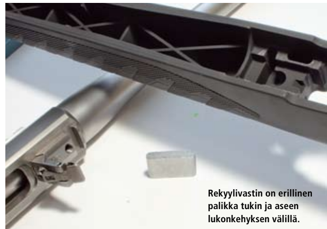
Piippukouru on auki ja noin 10 cm päässä rekyylivasteesta on tukipisteet, jotka ottavat piippuun. Täten ohuen piipun värähtelyyn on vaikutettu hieman. Yleensä tämä tasoittaa käyntiä ohutpiippuisissa aseissa muutaman laukauksen verran.
