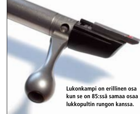
Lukon malli on sama kuin 85:ssä, mutta lukossa ei ole leikkauksia kontrolloidulle syötölle. Lisäksi ulosheitto on jousitoiminen 85:n mekaaniseen verrattuna.
