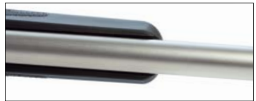
Piippukouru on auki ja noin 10 cm päässä rekyylivasteesta on tukipisteet, jotka ottavat piippuun. Täten ohuen piipun värähtelyyn on vaikutettu hieman. Yleensä tämä tasoittaa käyntiä ohutpiippuisissa aseissa muutaman laukauksen verran.
