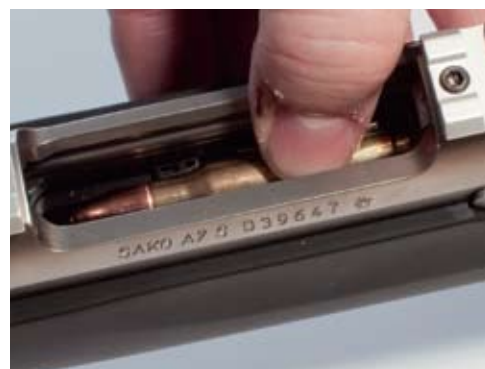
A7:n lipas on täytettävissä lippaan ollessa kiinni aseessa.
