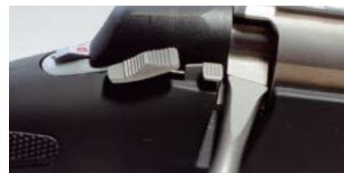
Varmistin on samanlainen kuin mitä se on ollut 75 mallista alkaen. Varmistin on kaksiasentoinen ja lukon saa varmistetusta aseesta avattua erillisellä salvalla.
