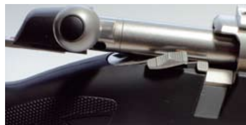
Varmistin on samanlainen kuin mitä se on ollut 75 mallista alkaen. Varmistin on kaksiasentoinen ja lukon saa varmistetusta aseesta avattua erillisellä salvalla.
