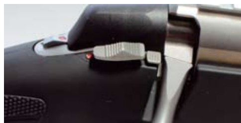
Varmistin on samanlainen kuin mitä se on ollut 75 mallista alkaen. Varmistin on kaksiasentoinen ja lukon saa varmistetusta aseesta avattua erillisellä salvalla.
